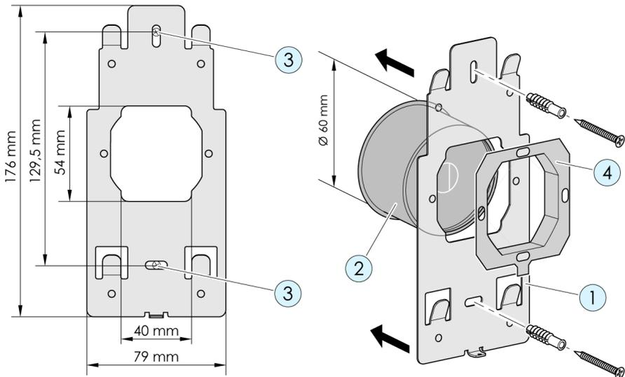
1. Platzieren Sie das Montageblech (1) auf einer Standard-Unterputzdose (2) oder einem passenden Freiraum im Mauerwerk. Die Aussparung im Montageblech muss passgenau auf der Unterputzdose sein.
